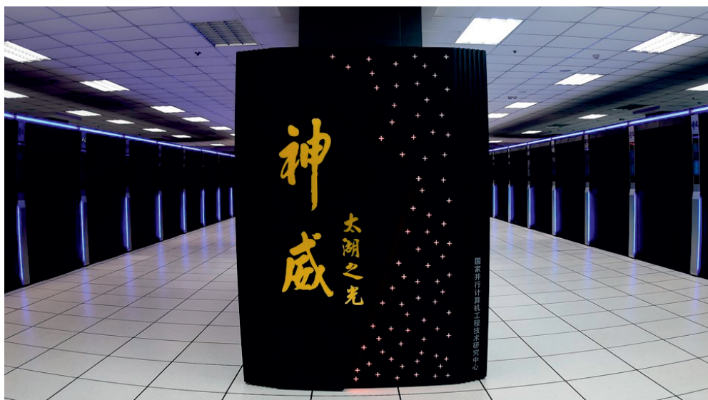
Рис. 3: Sunway TaihuLight 8 , Национальный суперкомпьютерный центр. 93 петафлопса, 40960 RISC процессоров, 4+256 ядер в каждом, частота — 1,45 ГГц, 10,6496 млн ядер, Оперативная память 1,31 ПБ, Пространство 605 м 2
